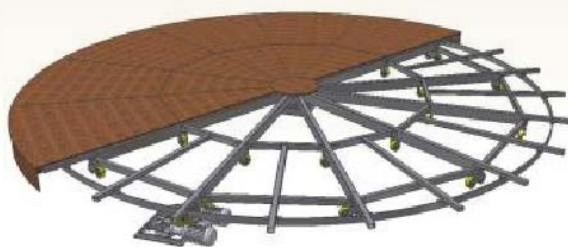
› A forgószínpad szerkezete
