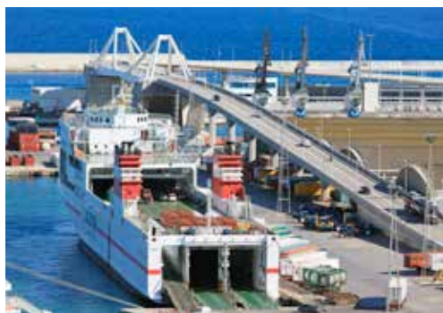
6.16. Közút-víziút kombinált szállítás (Ro-Ro = Roll on-Roll off = ki-be gördülő)
