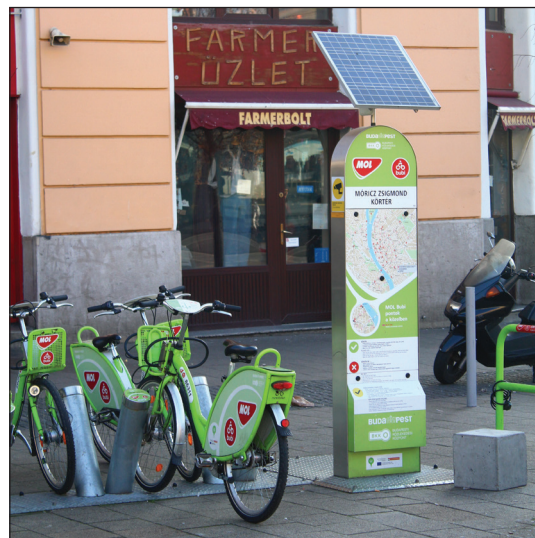
Budapesten a MOL Bubi közbringarendszer gyűjtőállomásain a vezérlő és kommunikációs egység energiaellátását napelemek biztosítják
