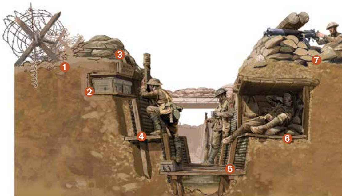
Egy brit lövészárk metszete. 1. szögcsodrótt akadályok, 2. lőszer tartó rekesz, 3. mellvéd, 4. lövészpad, 5. lábrács, 6. pihenőfedezék, 7. védett géppuskaállítás ■ Magyarázd meg, mire szolgálnak a lövészárk szám-mal jelzett részei!
