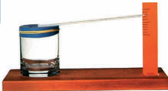
1. Egyszerű készülék a légnyomás változásának kimutatására
