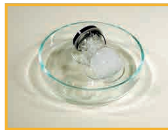
5. A víz fagyása a térfogat növekedésével jár. A képződő jég szétfeszíti az üveget.
